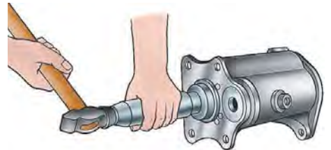
Рис. 3. Установка первинного валу в картер коробки передач
