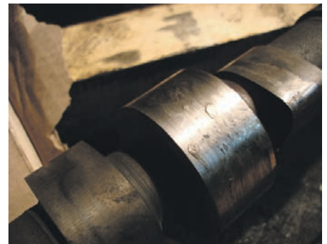
Рис. 1. Напливи на опірній шийці розподільного валу
