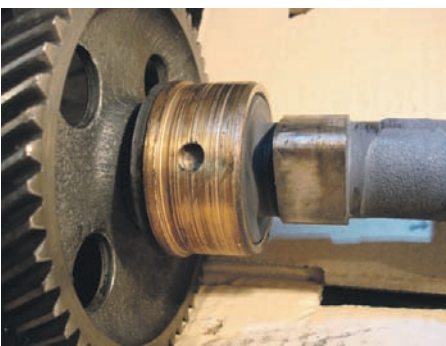
Рис. 3. Провертання втулки в блоці циліндрів
