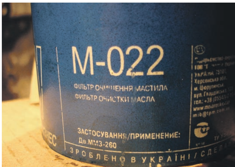
Рис. 6. Надпис на фільтрі не відповідає призначенню. Даний фільтр ЗАБОРОНЕНИЙ до використання ВАТ «УКХ» Мінський моторний завод на 6-ти циліндрових двигунах серії Д-260
