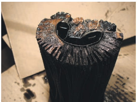
Рис. 5. Деформований фільтрувальний елемент із зірваним бандажем. Добре видно сліди неякісного приклеювання
