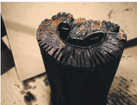
Рис. 5. Деформований фільтрувальний елемент із зірваним бандажем. Добре видно сліди неякісного приклеювання
