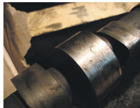
Рис. 1. Напливи на опірній шийці розподільного валу
