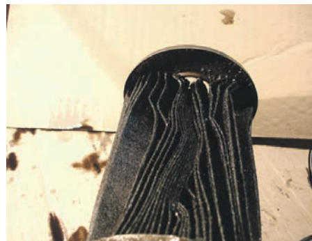
Рис. 4. Деформований і порваний фільтр
