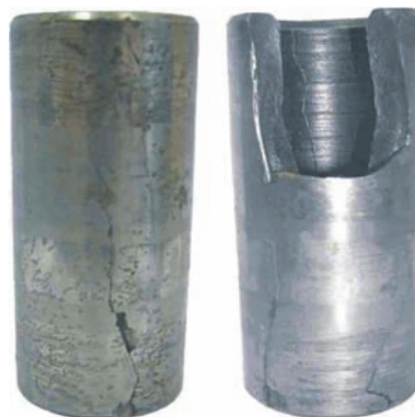
Рис. 3. Внешний вид после работы: поршневой палец полностью сломан на переходе между стержнем шатуна и бобышкой поршня, на поршневом пальце присутствует поперечная трещина; наблюдается трещина на коротком участке по длине пальца.
