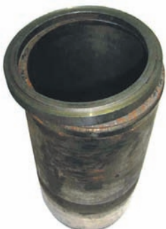
Рис. 2. Признак появления неисправности, внешний вид после работы: отрыв бурта гильзы, трещина начинается с радиуса под буртом и наклонно продолжается вверх.
