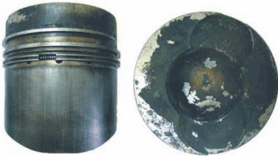
Рис. 1. Признак появления неисправности, внешний вид после работы: на поршне видны узкие бороздки с четкими следами истирания по всей длине юбки поршня, на кольцах имеются царапины.
