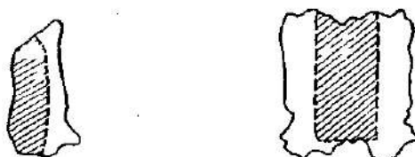
Рисунок 1.5 – Схематичне зображення туші із зняттям крупону: ліворуч – туша зі знятим крупоном; праворуч – контур шкіри і крупону
