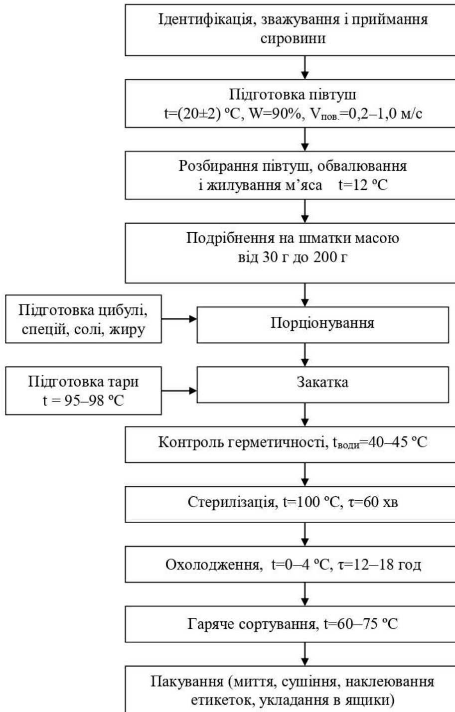
Рисунок 2.34 – Технологічна схема виробництва консервів натуральних
