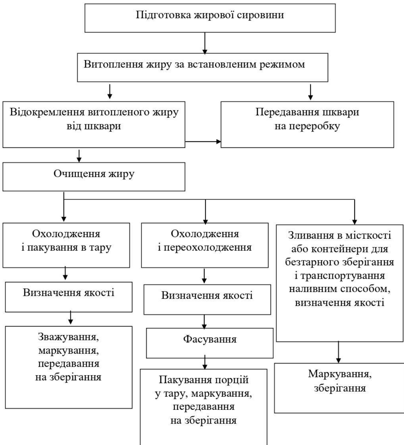
Рисунок 1.9 – Технологічна схема виробництва тваринних жирів
