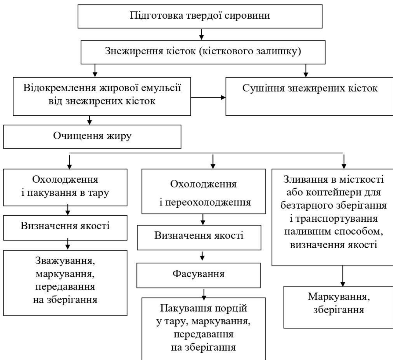
Рисунок 1.10 – Технологічна схема виробництва тваринних жирів із твердої сировини
