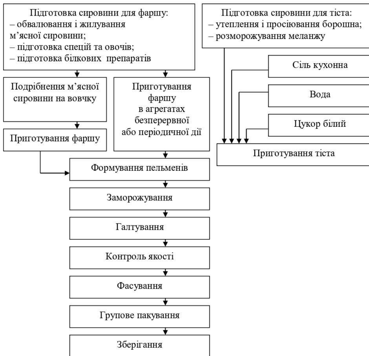
Рисунок 2.5 – Принципова технологічна схема виробництва пельменів
