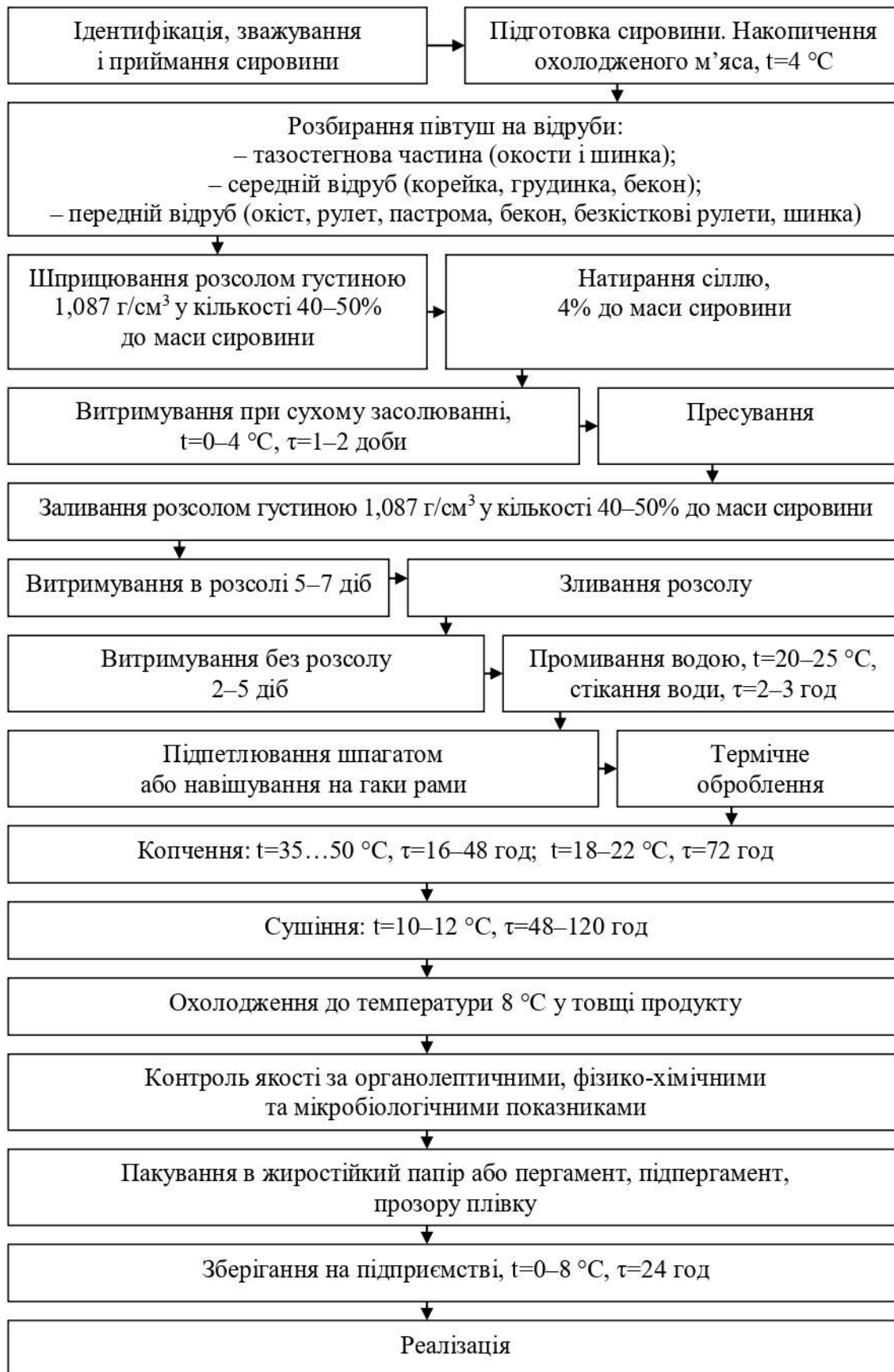
Рисунок 2.33 – Технологічна схема виробництва сирокопчених виробів зі свинини
