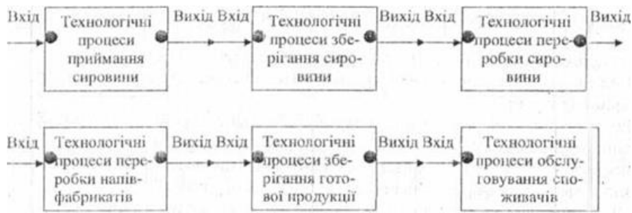
Рисунок 3.5 – Модель формування зв'язків технологічних процесів у системі технології
