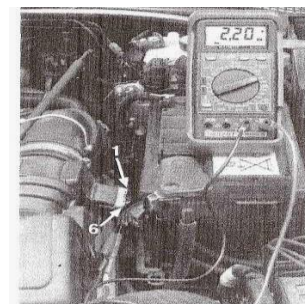
Рис. 2.128. Перевірка витратоміра повітря з допомогою мультиметра здійснюється на контактах 1 і 6
