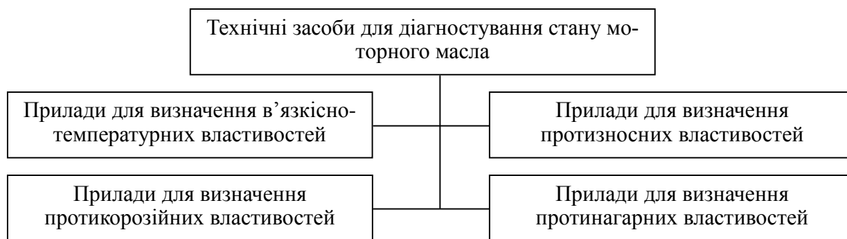
Рис. 1.80. Класифікація технічних засобів діагностики стану масла
