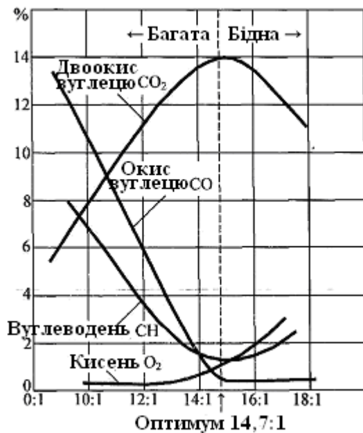
Рис. 1.85. Склад ВГ в залежності від співвідношення повітря/пальне в суміші
