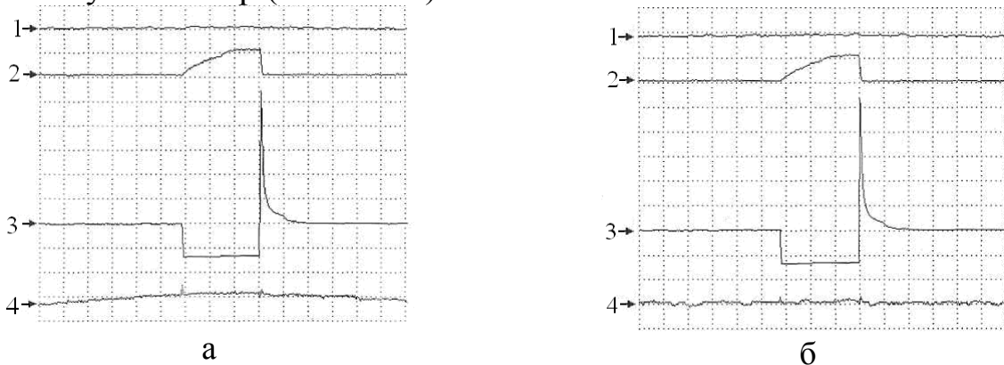
Рис. 2.32. Осцилограми витрати повітря (1), сили струму на управляючому сигналі форсунки (2), сигналу управління паливною форсункою (3) і тиску пального (4) на усталеному режимі роботи двигуна: а – датчик PST-F; б – PSS-260
