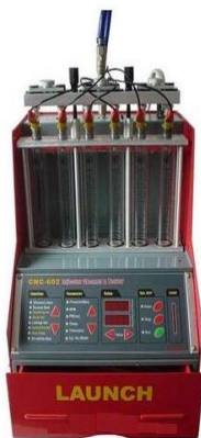
Рис. 1.55. Стенди моделей LAUNCH CNC-602A (а) і Триумф-4М (б) для контролю технічного стану й очищення форсунок
