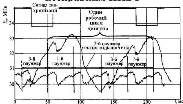
Рис. 2.61. Тиск в акумуляторі й управляючий сигнал на регуляторі тиску в режимі запуску двигуна CR 14CO Mercedes Vito 108CDI зі справним та несправним ПНВТ
