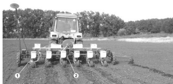
Рис. 3. Рабочее положение инерционных измерительных приборов МИС на посевной секции (1) и раме (2) сеялки
