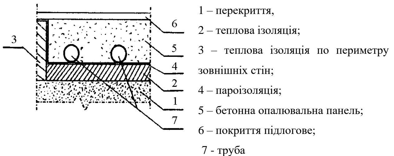
Рис.12 Розміщення нагрівальних елементів у підлозі
