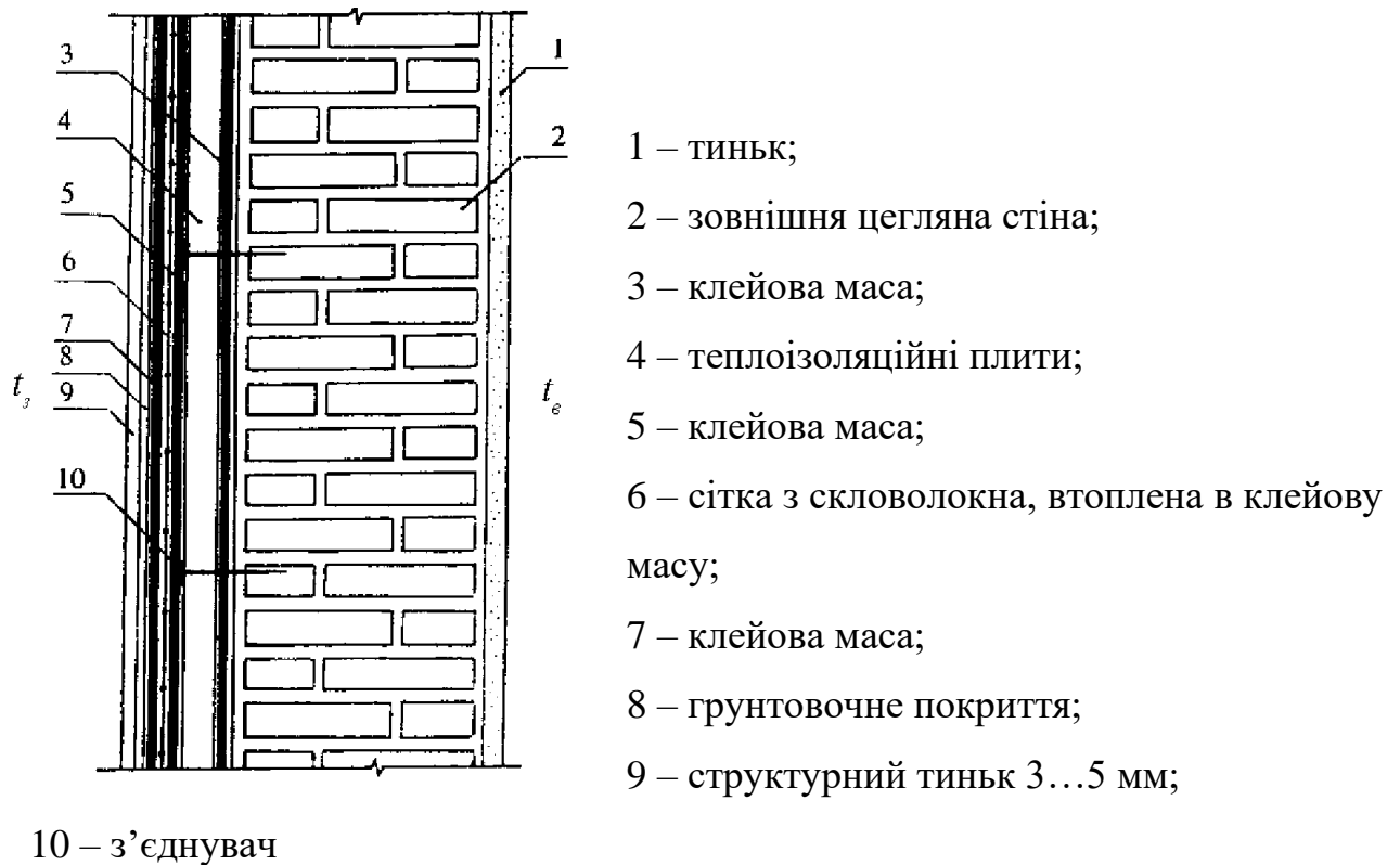
Рис.6 Конструктивне рішення до утеплення стін існуючих будинків
