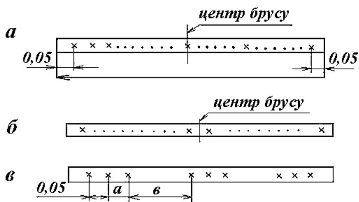
Рис. 27. Схема розмітки на брусі для розстановки сошників:
