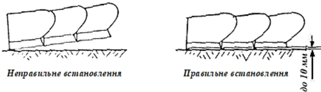
Рис. 19. Схема установки плуга в поперечній площині
