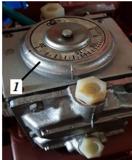
Рис. 13. Регулювання витрати суспензії: 1 - диск регулювання кроку діафрагми насоса-дозатора
