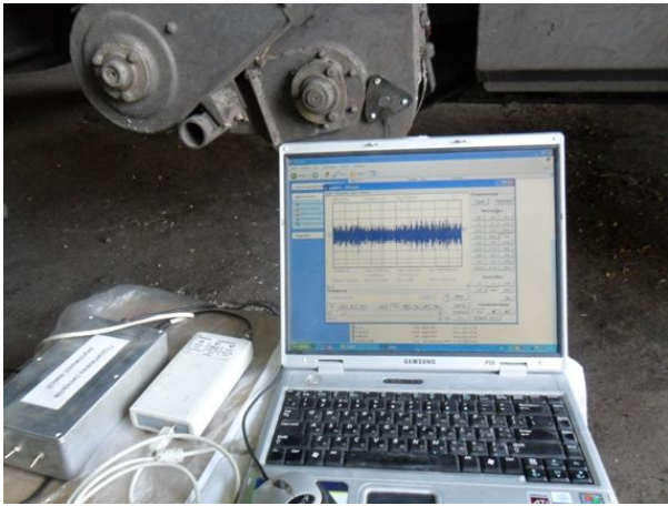
а) – дослідження комбайну LEXION 670 , б) – дослідження комбайну ДОН-1500 Рисунок 9 – Система реєстрації сигналів акустичної емісії
