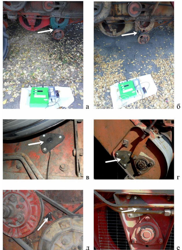
а, б – діагностування приводу зернового шнека, в – діагностування приводу переднього контрприводного вала, г – діагностування приводу елеватора, д – діагностування приводу молотильного барабану, е – діагностування вентилятора
