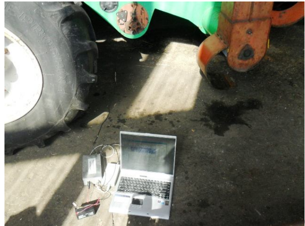
а) – дослідження комбайну LEXION 670 , б) – дослідження комбайну ДОН-1500 Рисунок 9 – Система реєстрації сигналів акустичної емісії
