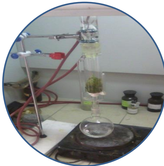
Рис.4.25. Спиртова екстракція за допомогою приладу Сокслета.
