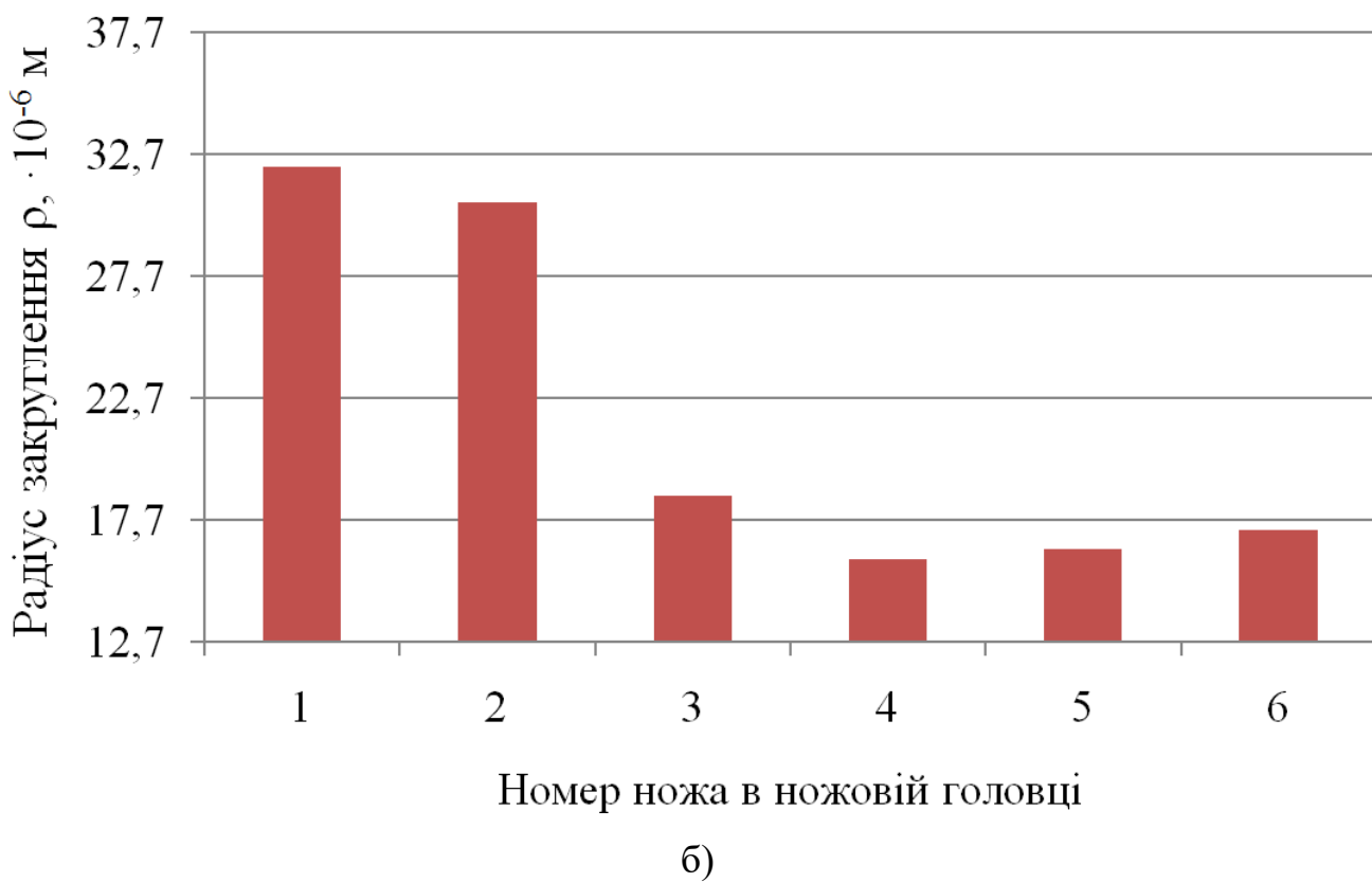
Рис. 3.12. Радіуси закруглення різальних окрайків ножів після кутування тонкоподрібнених безструктурних фаршів: а) - для точки №1; б) - для точки №2
