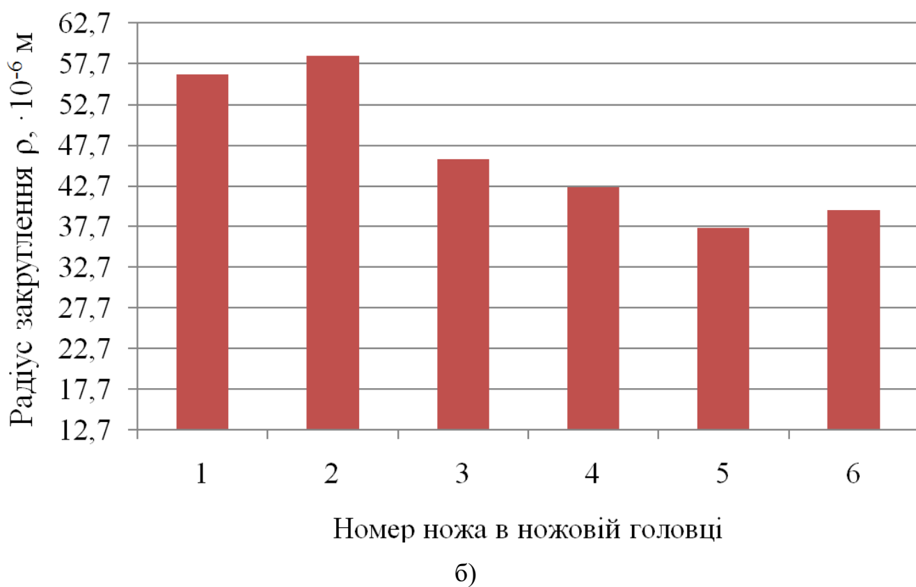
Рис. 3.15. Радіуси закруглення різальних крайків ножів після кутерування фаршів сирокочених ковбас: а) - для точки №2; б) - для точки №3
