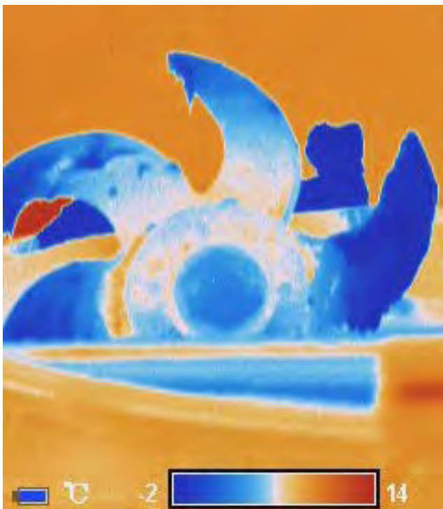
Рис. 3.34. Положення сировини та елементів кутера при термографії та поля їх температур (вид спереду, кришка ножової головки відкрита): а) - загальний вид кутера; б) - температура ножів та сировини на них; в) - поля температур сировини та ножів після зупинки чаші та ножової головки
