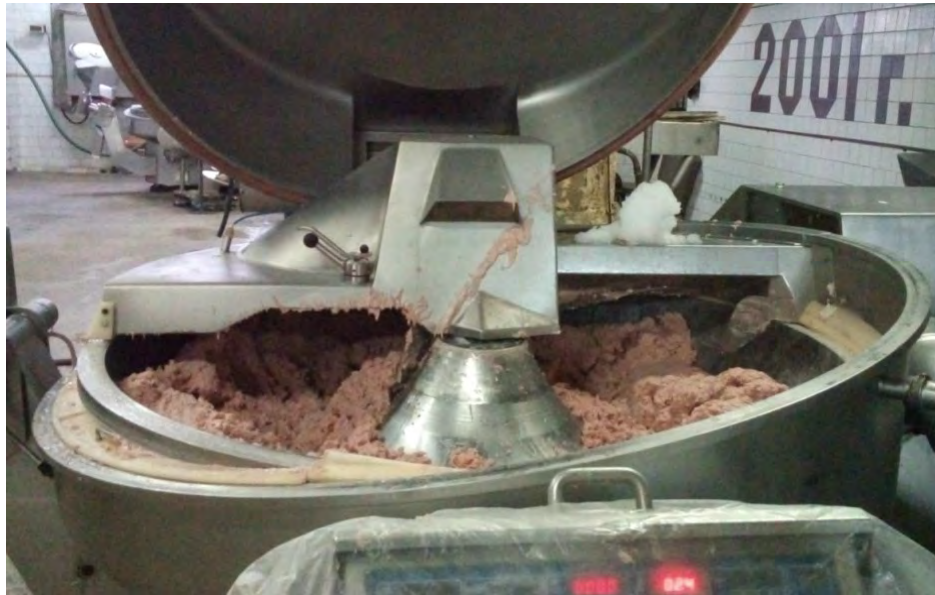
Рис. 3.29. Положення сировини та елементів кутера при їх термографії (вид збоку, кришка ножової головки закрита)
