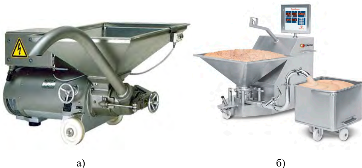
Рис. 1.8. Зовнішній вигляд емульсифікаторів: а) - марки "Karl Schnell FD 175" з горизонтальною віссю обертання РВ та заднім розташуванням приводу; б) - марки "Seydelmann Konti-Kutter KK 140" з вертикальною віссю обертання РВ
