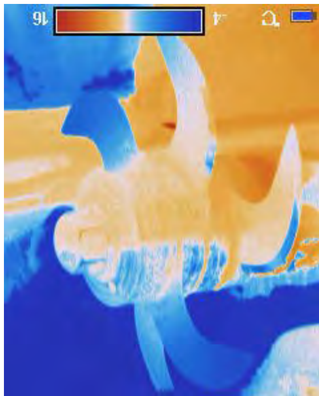
Рис. 3.32. Положення сировини та елементів кутера при термографії та поля їх температур (вид збоку, кришка ножової головки відкрита): а) - загальний вид кутера; б) - температура елементів ножової головки
