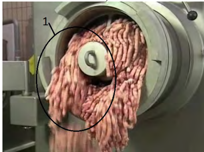
Рис. 3.37. Зміна положення зони інтенсивної подачі сировини 1 при обертанні шнека вовчка (отримання фаршу з парної м'ясної сировини)
