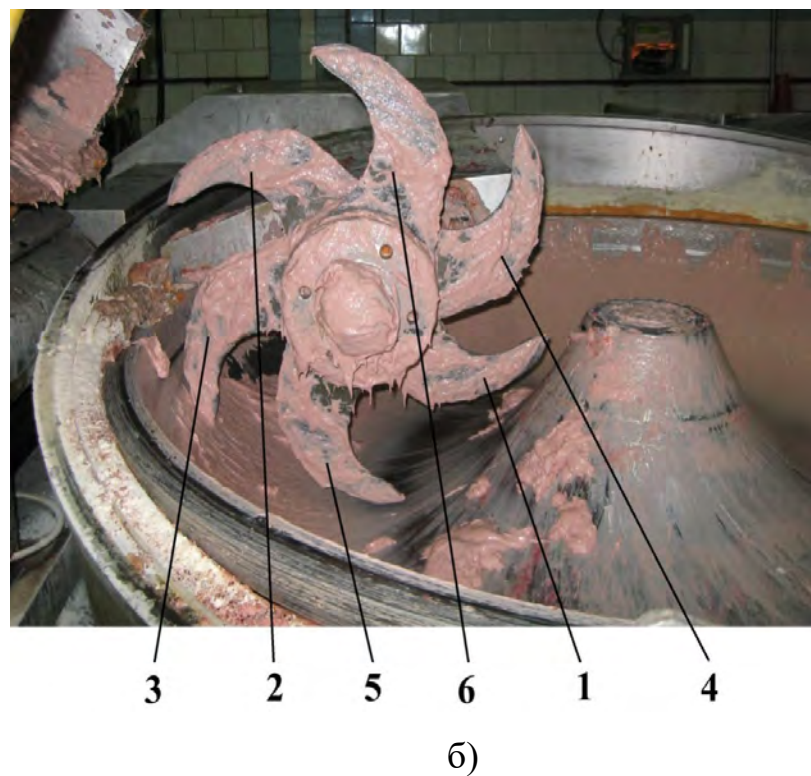
Рис. 3.1. Розміщення ножів в ножовій головці кутера Laska KR-330V: 1, 2 - ножі першої площини різання; 3, 4 - ножі другої площини різання; 5, 6 - ножі третьої площини різання
