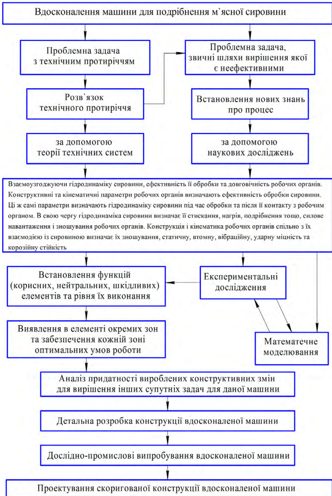
Рис. 2.28. Структурна схема реалізації запропонованої концептуальної гіпотези вдосконалення і розвитку машини для подрібнення м'ясної сировини в контексті застосування науково-винахідницького біному
