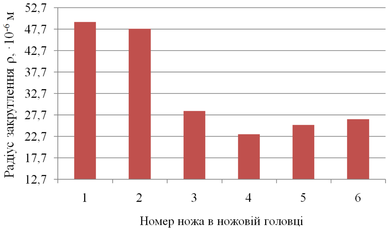
Рис. 3.13. Радіуси закруглення різальних крайків ножів після кутерування тонкоподрібнених безструктурних фаршів, для точки №3
