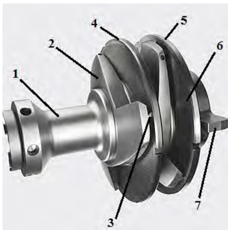
Рис. 1.9. Будова різального вузла типу "ніж-решітка": 1 - ножовий вал; 2 - ніж; 3 - змінна різальна вставка; 4 - приймальна перфорована решітка; 5 - вихідна перфорована решітка; 6 - радіальні ребра жорсткості решітки; 7 - лопаті вивантажувальної крильчатки
