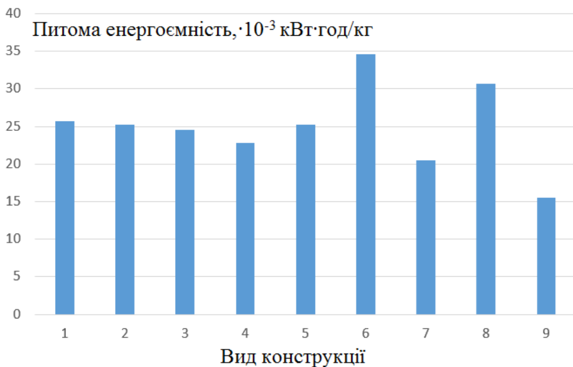
Рис. 5.40. Вплив конструктивного виконання елементів ножової головки на продуктивність та питома енергоспоживання кутера: а) – продуктивність; б) – питома енергоспоживання; 1 – стандартна ножова головка; 2 – ніж із пазами; 3 – ніж похилий; 4 – накладний пристрій; 5 – ніж дисковий; 6 – ножовий блок зміщений; 7 – ніж збірний; 8 – динамічний пристрій; 9 – статичний пристрій
