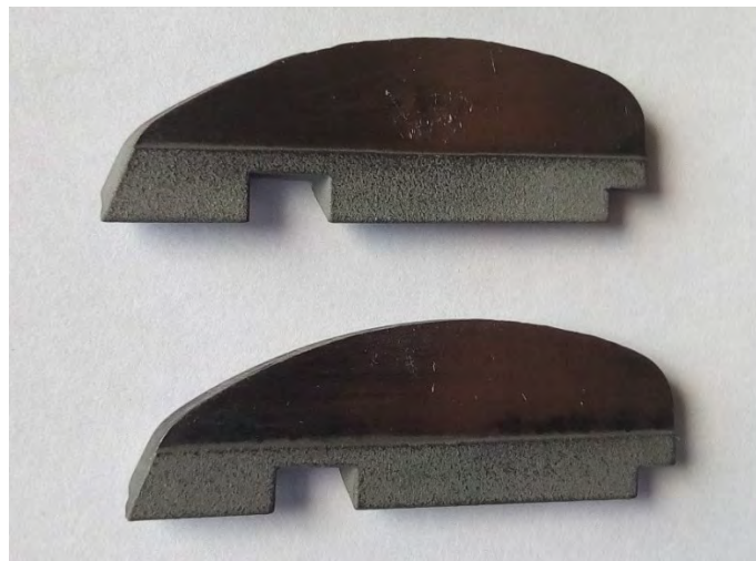
Рис. 5.69. Фотографія лез ножа емульсатора з нанесеним зносостійким металокерамічним покриттям WC-Co 88/12
