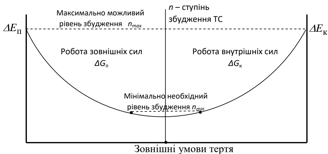
Рис. 1. Схематичне зображення роботи ТС в умовах АНТЗ
