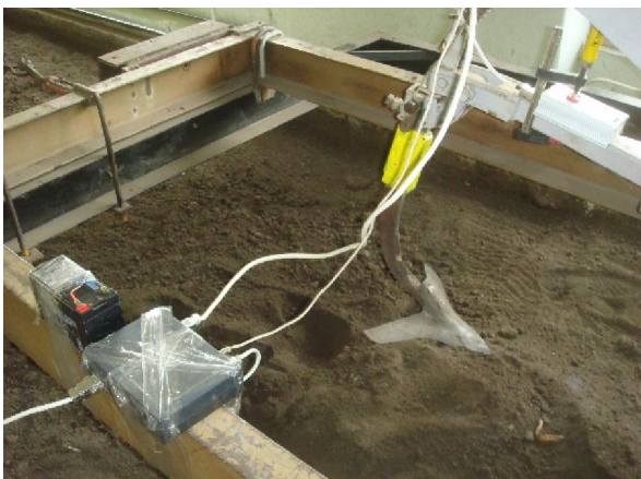
Рис. 9. Засоби вимірювання витрат на тертя культиваторних лап в ґрунтовому каналі
