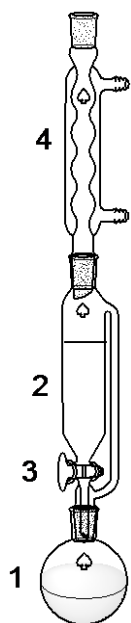
Рис. 2.3. Схема установки для визначення числа аромату, де 1 – перегінна колба; 2 – воронка; 3 – кран; 4 – зворотний холодильник
