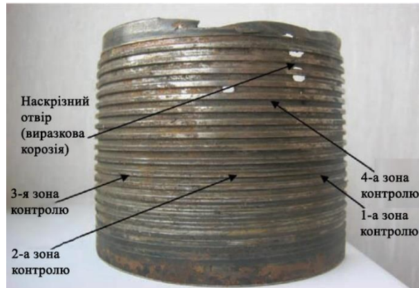
Рисунок 3 – Різьбове з'єднання зовнішньої поверхні (фрагмент НКТ), зруйноване виразковою корозією
