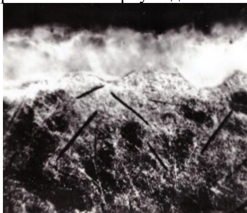
Рисунок 5 – Мікроструктура поперечного перерізу ливарного сплаву АЛ9 після мікродугового оксидування (x 300)
