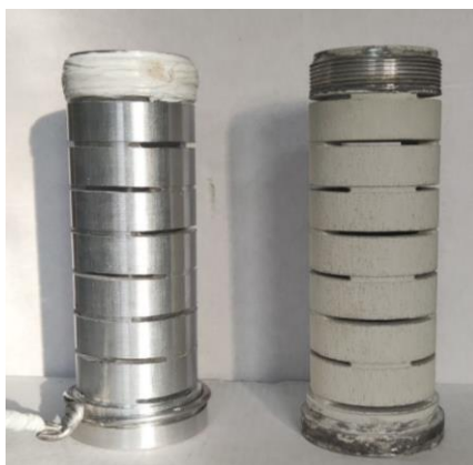
Рисунок 28 – Калібратори для виготовлення поліпропіленових труб
