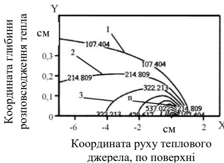
1,2,3...n – ізотерми поширення тепла на різну глибину в зразку Рисунок 6 – Схематичний вид зміни температурного поля в зразку зі сталі 15X11МФ при його ТФЗ
