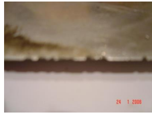
Рисунок 13 – Деревообробний різець зі сталі У8А після експлуатації протягом 3 годин (а) та деревообробний ніж із сталі 65Г після експлуатації протягом 8 годин (б)
