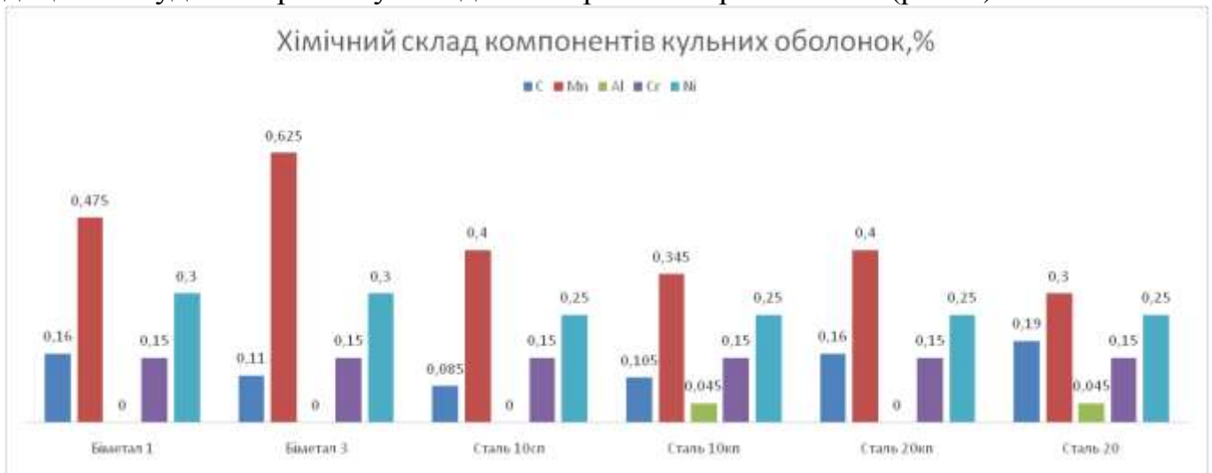
Рисунок 2 - Хімічний склад компонентів кульних оболонок, %
