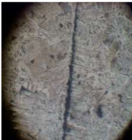
Рисунок 9 - Розподіл компонентів по перетину відновленого шару, перехідної зони і основного металу при оптимальних модифікуючих домішках
