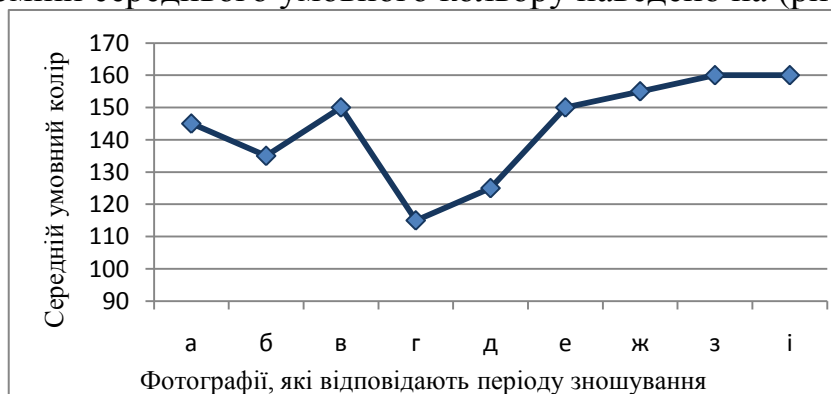
Рис. 7. Зміна усередненого умовного кольору фотографій, характеризуючих інтенсивність зношування поверхні в процесі тертя
