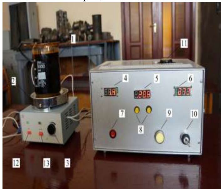
Рис. 10. Обладнання для хромування з модифікуванням покриттів: 1 - термостійка колба з електролітом; 2 - ТЕН для підігріву електроліту; 3 - регулятор частоти обертання електромагніту; 4 - цифровий вольтметр; 5 - цифровий термометр; 6 - цифровий амперметр; 7 - включення ТЕНу; 8 - включення функції гістерезису термометра; 9 - індикаторна лампа включення установки; 10 - електрозамок включення установки; 11 - регулятор щільності струму електроліту; 12 – включення електромагнітної мішалки; 13 - включення електромагніту
