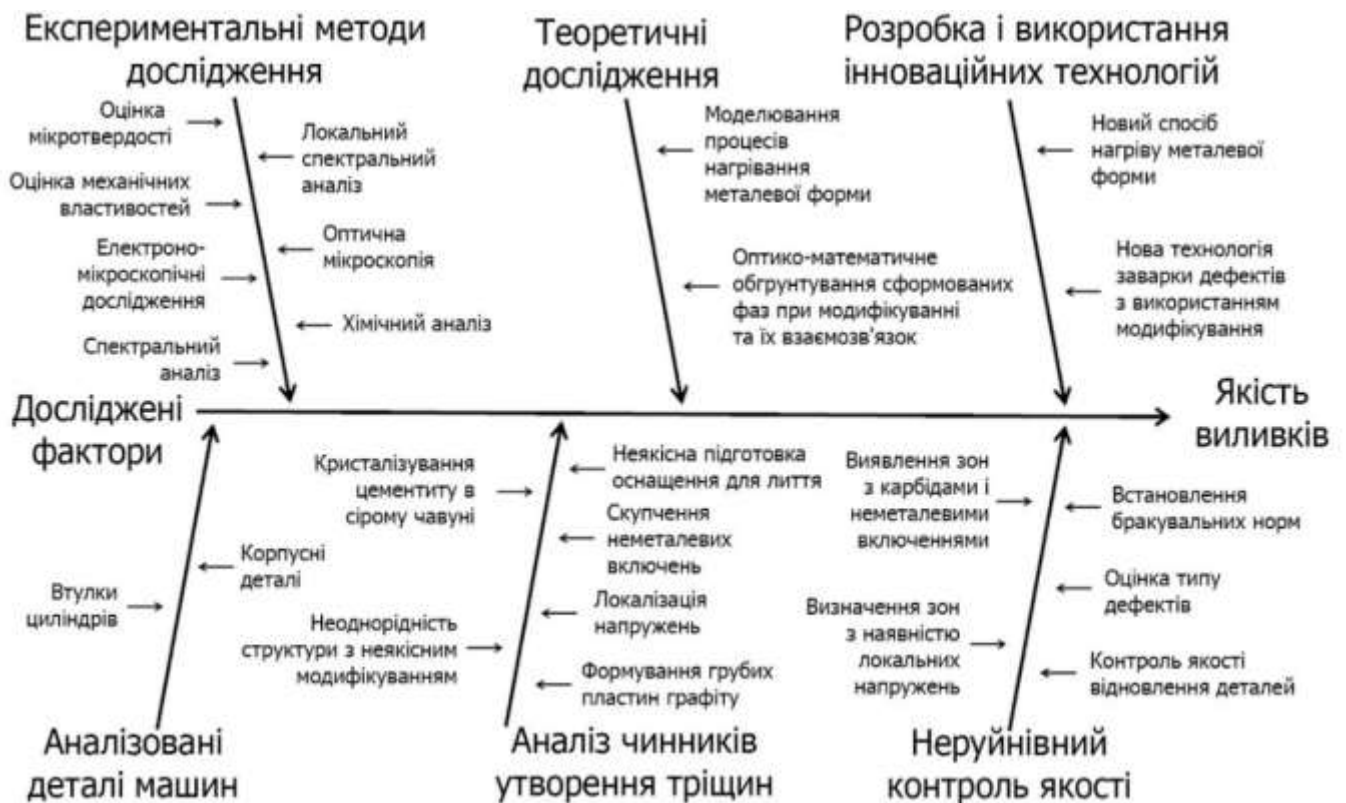
Рисунок 1 – Напрями досліджень, які використовували для підвищення якості виливків та розробки нових технологій
