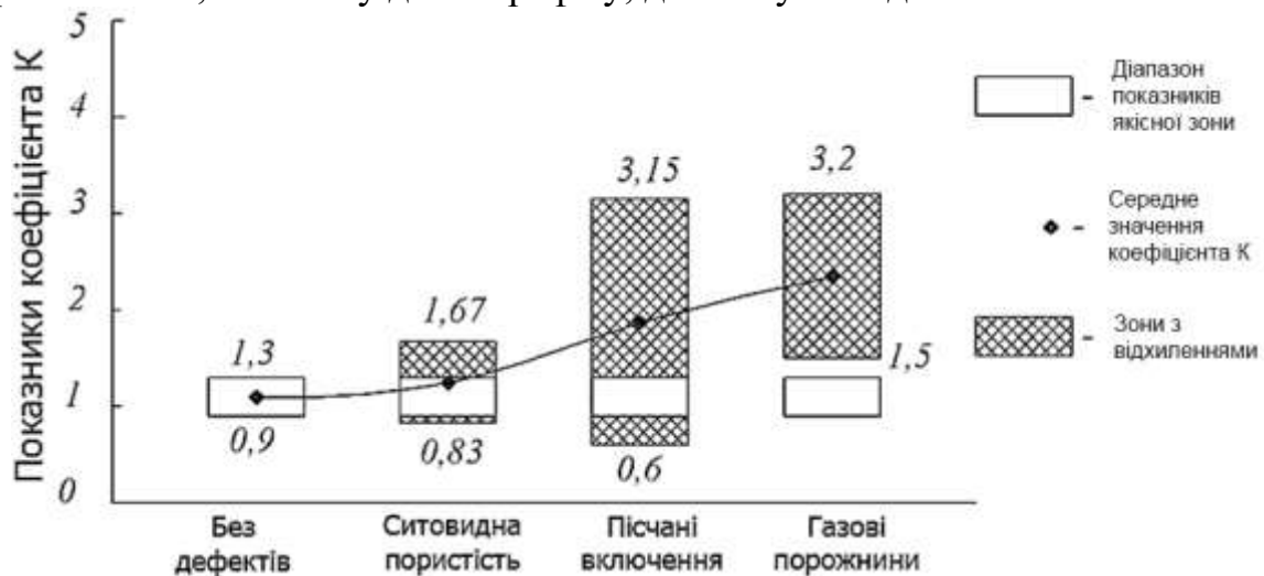
Рисунок 17 – Характер зміни показників коерцитивної сили від значень коефіцієнтів K у якісній зоні та при наявності різних дефектів
