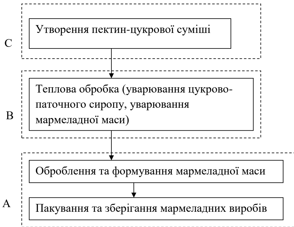
Рис. 4.1 Модель технологічної системи виробництва мармеладу желейно-фруктового з використанням рослинних кріодобавок
