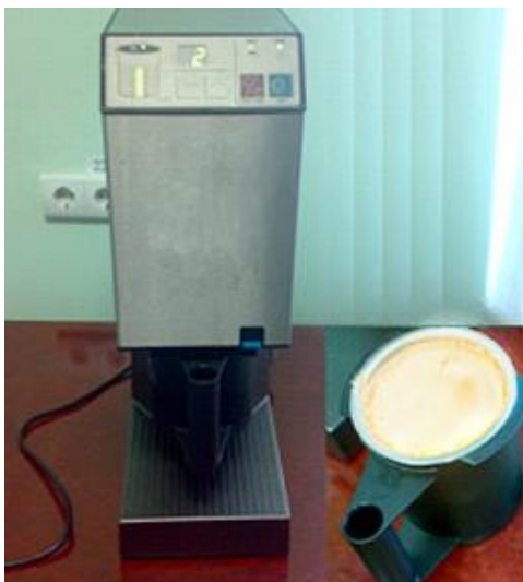
Рис. 2.10 – Низькотемпературний подрібнювач-активатор заморожених продуктів (Франція)
