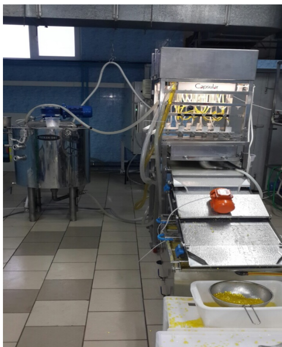
Рис. 5.34. Фотографічне зображення пристрою УЖК-20 для одержання ЛХСК у середовищі повітря
