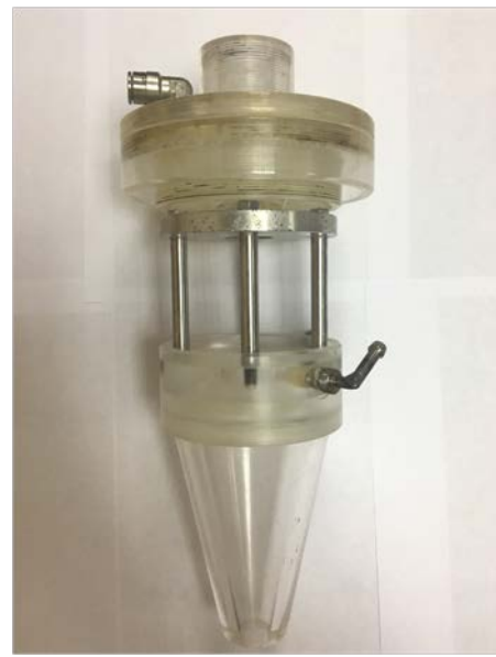
Рис. 2.8. Фотографічне зображення промислових зразків головок для капсулювання: 1 – у середовищі повітря; 2 – у середовищі олії дезодорованої
