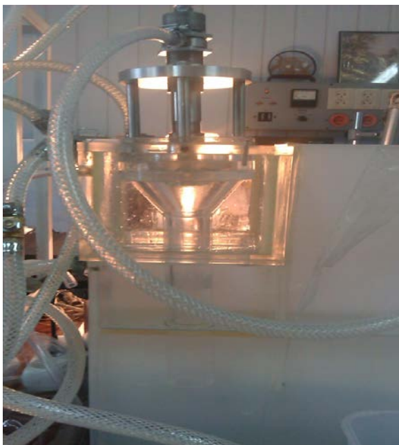
Рис. 2.9. Експериментальні екструзійні пілотні установки для капсулювання ЛХС: 1 – у середовищі олія дезодорована; 2 – у середовищі повітря
