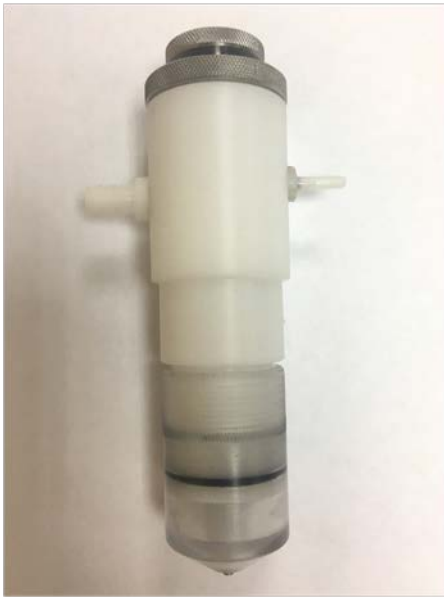
Рис. 2.8. Фотографічне зображення промислових зразків головок для капсулювання: 1 – у середовищі повітря; 2 – у середовищі олії дезодорованої
