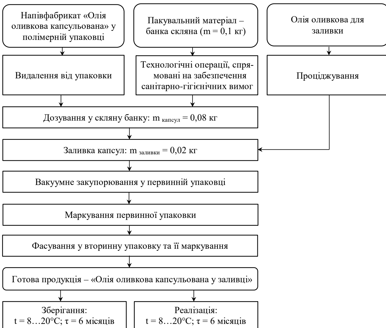
Рис. 5.2. Технологічна схема одержання готового продукту «Олія оливкова капсульована у заливці»
