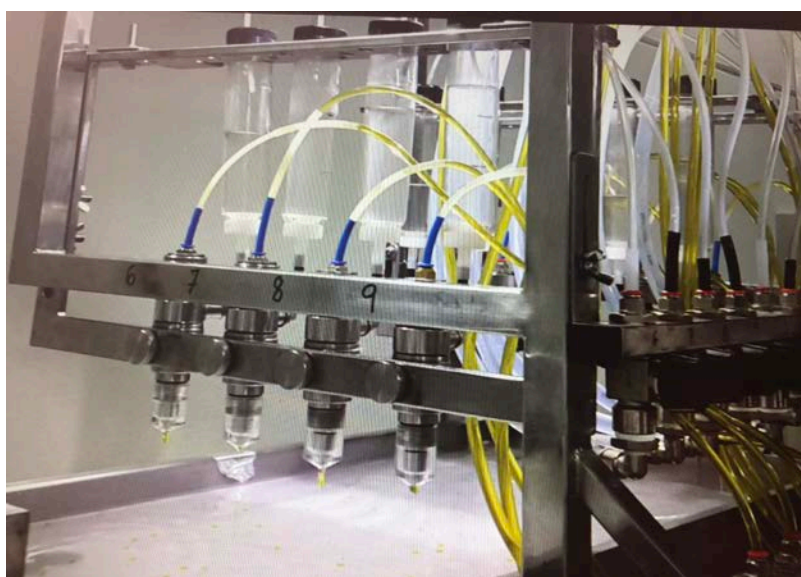
Рис. 5.32. Ділянка екструзії рецептурних сумішей у формуючий розчин \text{Ca}^{2+}
