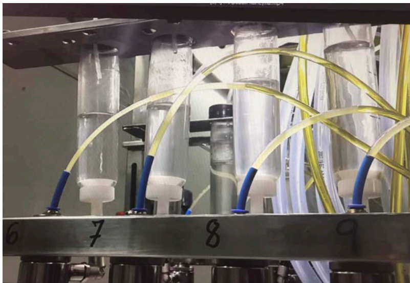
Рис. 5.31. Ділянка розподільних колекторів, призначених для формування раціонального рівня рецептурних сумішей
