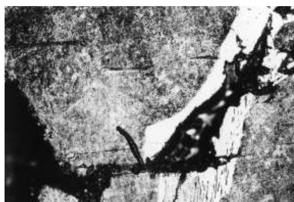
Рисунок 2 – Зростання включень графіту при експлуатації валків в умовах дії високих циклічних питомих тисків і підвищених температур, \times 100
