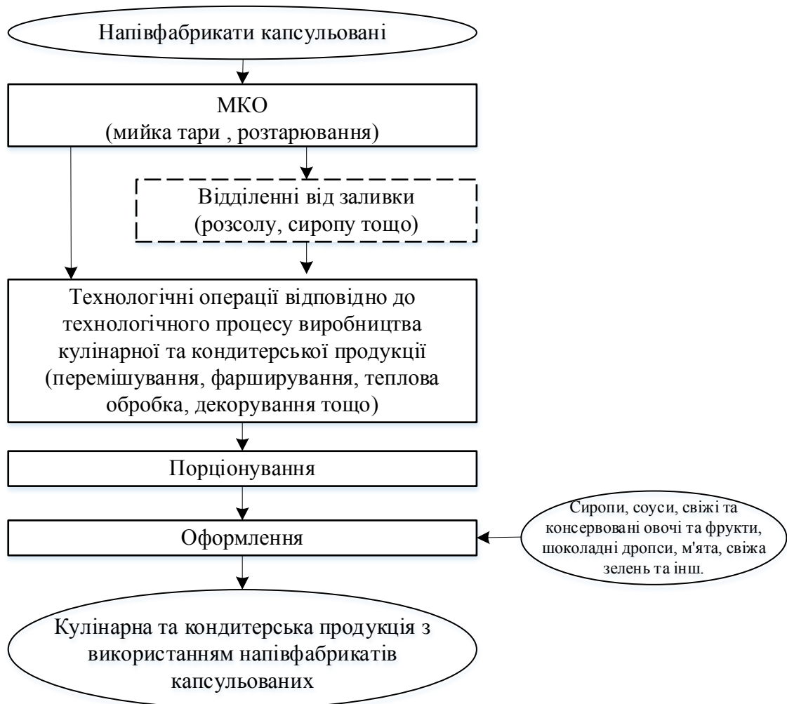
Рис. 5.19. Принципова технологічна схема виробництва кулінарної та кондитерської продукції з використанням напівфабрикатів капсульованих
