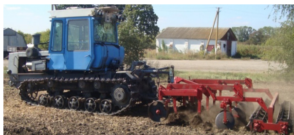
Рис. 3. Загальний вигляд ґрунтообробного агрегату із серійною начіпною системою на базі трактора ХТЗ-200 і культиватора КЛД-3,0
