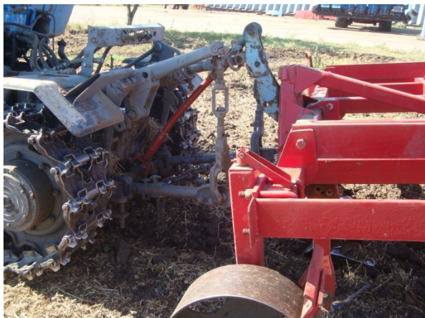
Рис. 4. Ґрунтообробний агрегат із експериментальною начіпною системою на базі трактора ХТЗ-200 і культиватора КЛД-3,0
