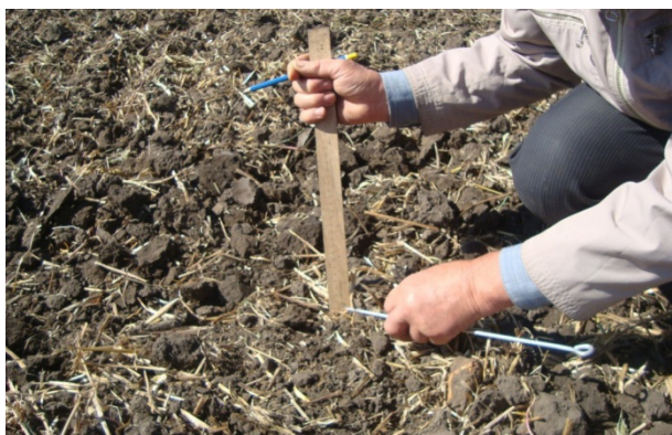
Рис. 5. Визначення глибини ходу культиватора КЛД-3,0 в складі ґрунтообробного агрегату на базі трактора ХТЗ-200
