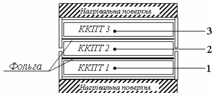
Рисунок 3.18 – Схема розміщення термодатчиків та листів алюмінієвої фольги між шарами ККПТ під час моделювання ІнтМО за горизонтальної орієнтації сировини з газонепроникними включеннями (1, 2, 3 – термодатчики у відповідних шарах ККПТ)
