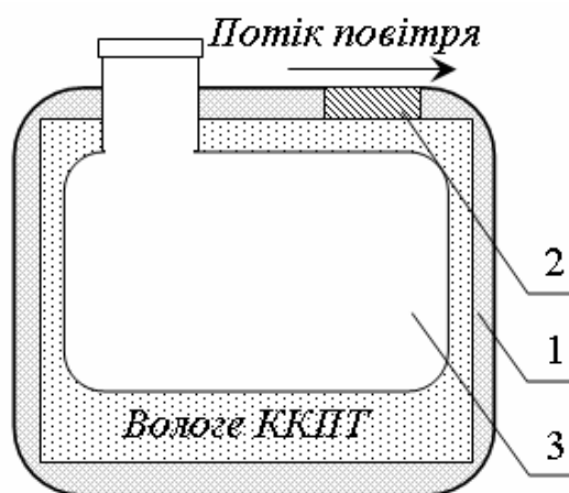
Рисунок 5.10 – Схема апарата для охолодження та термостатування з використанням ефекту ІнтМО: 1 – термостат; 2 – обтюратор; 3 – ємність для сировини, яка підлягає охолодженню або термостатуванню
