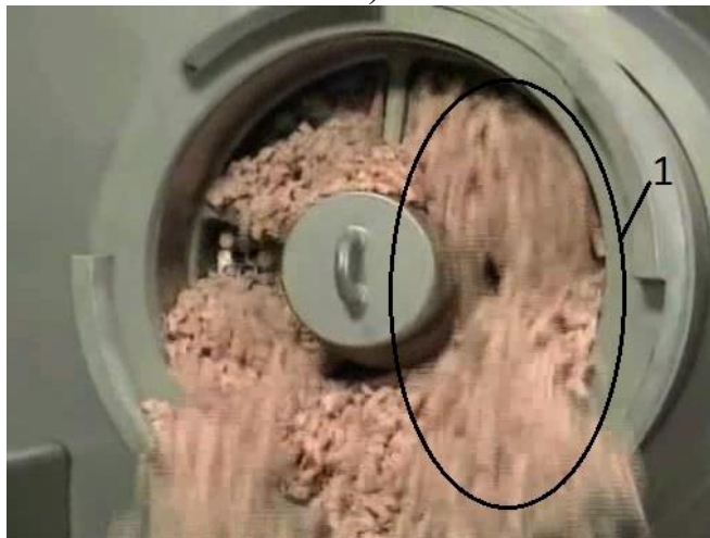
Рис. В.5. Зміна положення зони інтенсивної подачі сировини 1 при обертанні шнека вовчка (отримання м'ясного фаршу з замороженої сировини)
