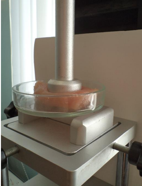
Рис. Б.4. Індентор циліндричний універсальної випробувальної машини SANS CMT2503 (досліджується яловичина)
