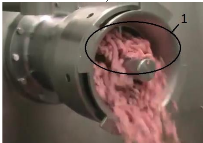
Рис. В.8. Зміна положення зони інтенсивної подачі сировини 1 при обертанні шнека вовчка (отримання м'ясного шроту з парної сировини)
