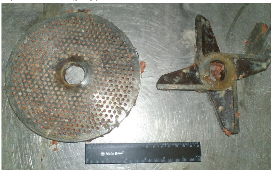
Рис. А.11. Вихідна решітка та ніж вовчка VVS-180
