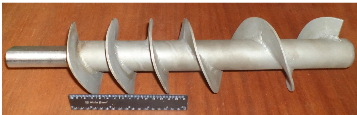
Рис. А.3. Шнек вовчка АЛ-130 зі збільшеним кроком витків
