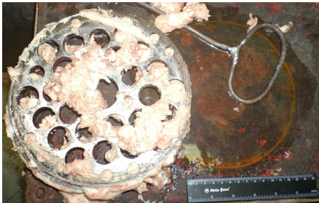
Рис. А.15. Вихідна решітка вовчка К6-ФВЗП-200
