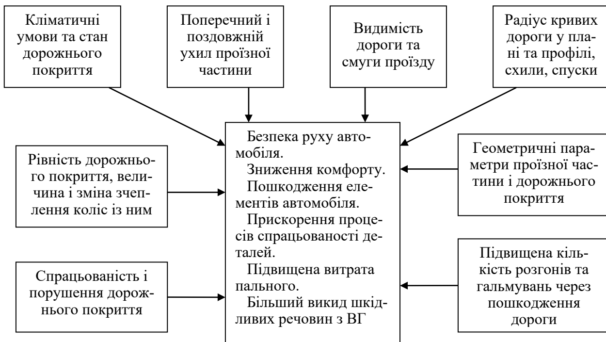
Рис. 2.1. Основні параметри дорожніх умов, що впливають на безпеку та технічний стан автомобілів
