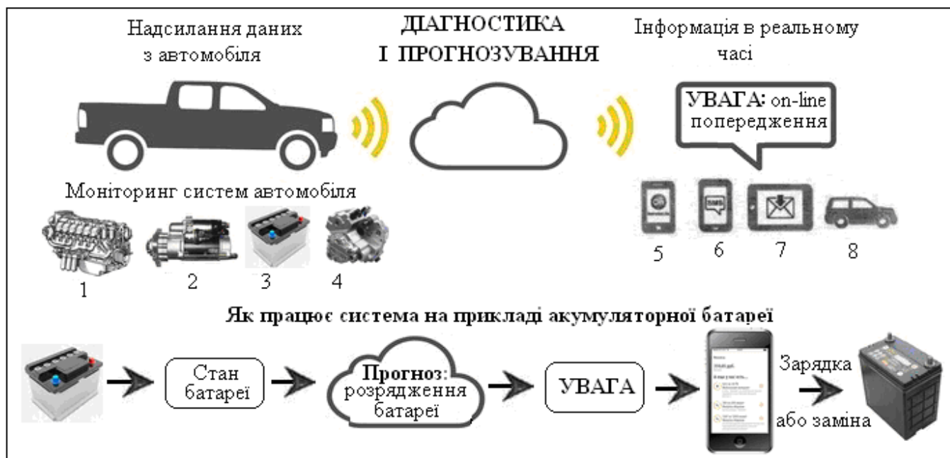
Рис. 7.21. Технологія Proactive Alerts для діагностування та прогнозування технічного стану:
