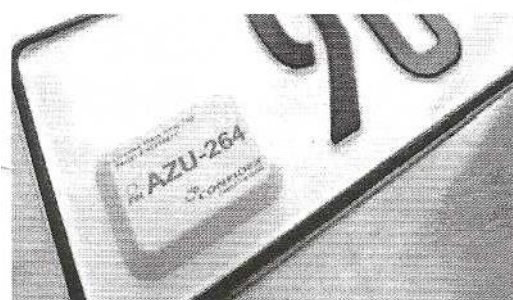
Рис. 6.4. Приклад кріплення RFID-мітки для ідентифікації автомобіля (на державному реєстраційному номері)
