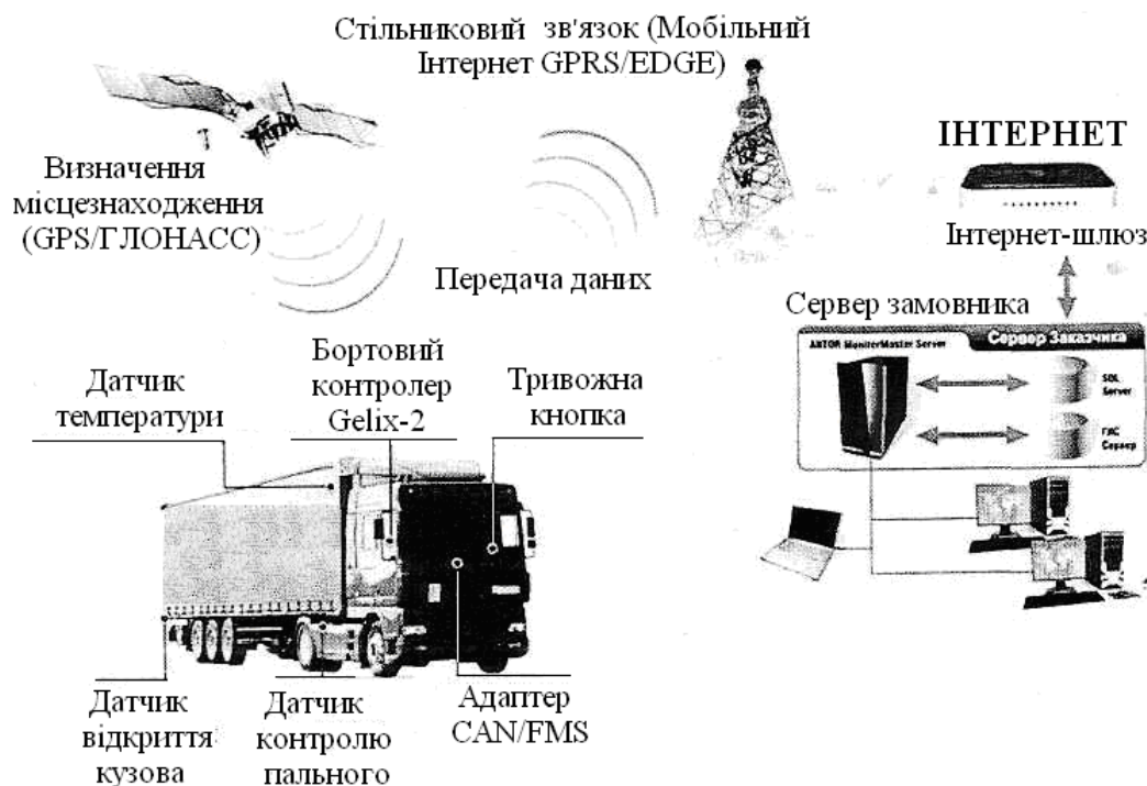
Рис. 6.23. Загальна структура трекінгових систем реального часу
