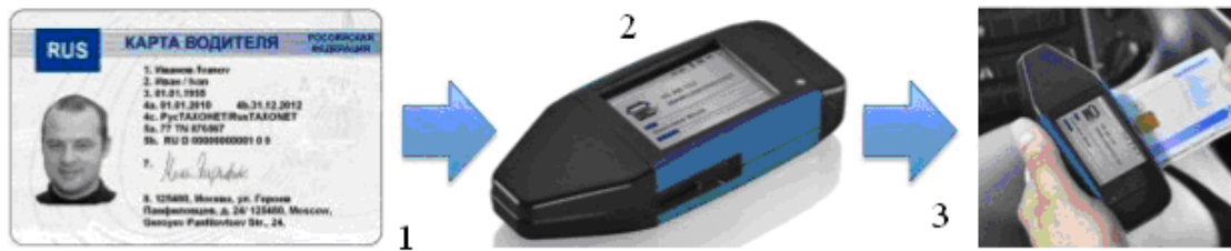
Рис. 6.17. Зчитування даних с карти с допомогою завантажувача:
