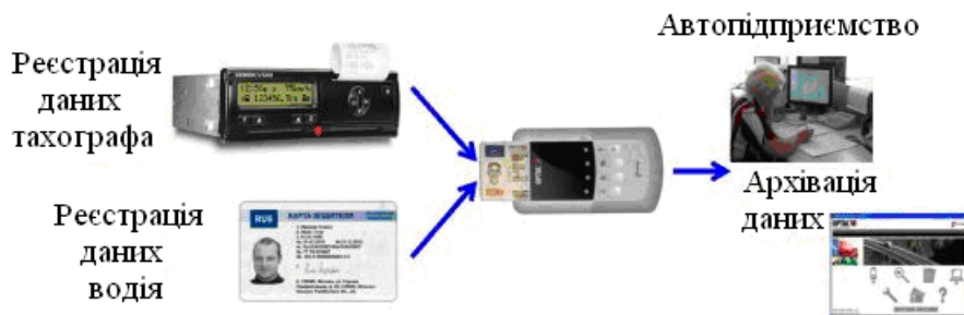
Рис. 6.13. Схема використання даних у системі транспортного моніторингу
