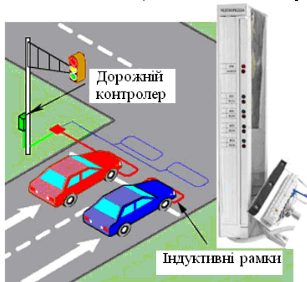
Рис. 4.10. Схема встановлення індуктивних детекторів
