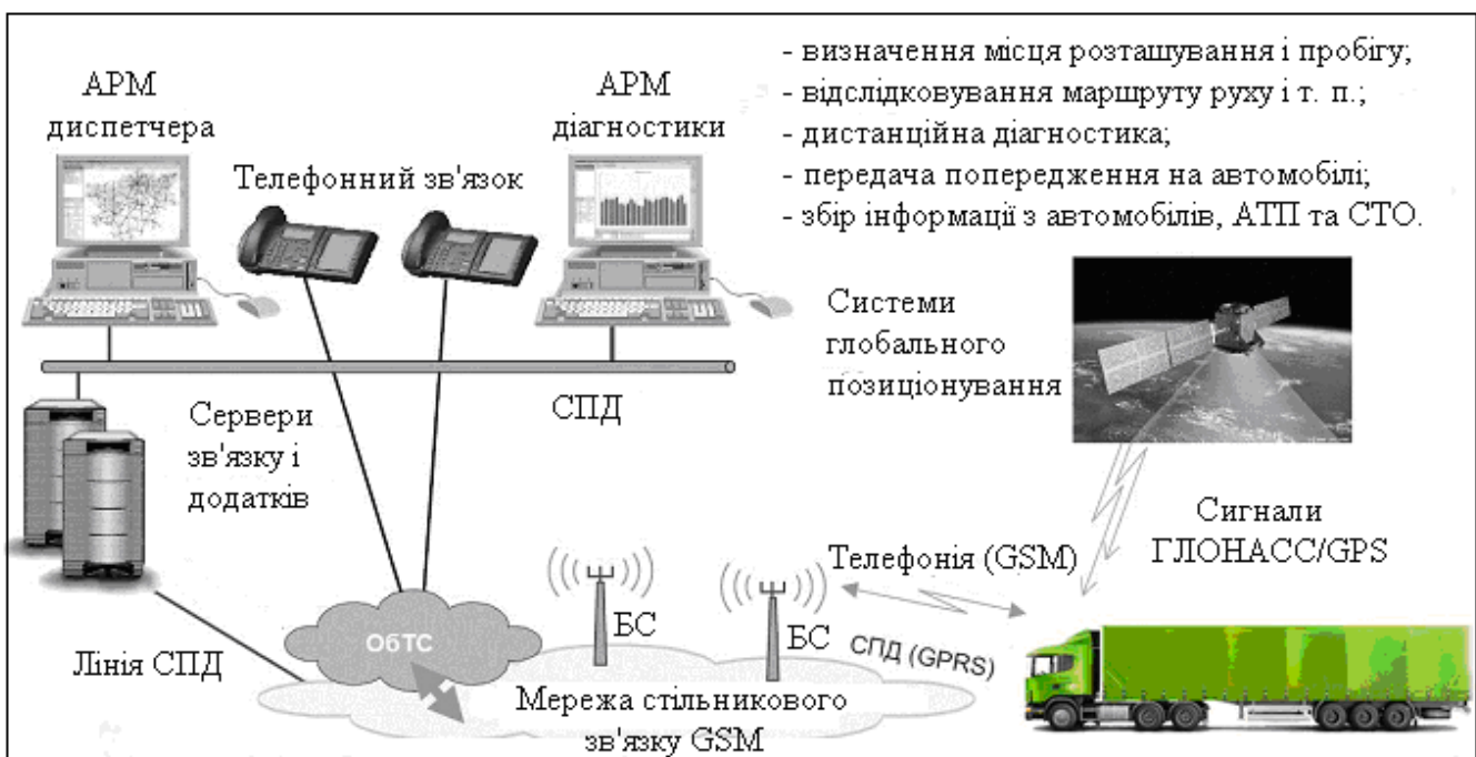
Рис. 5.19. Спрощена схема моніторингу транспортних засобів:
