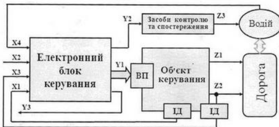
Рис. 9.10. Узагальнена функціональна схема системи «автомобіль-водій-дорога»:
