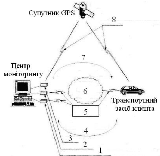
Рис. 6.25. Схема корпоративного центра моніторингу мобільних об'єктів:
