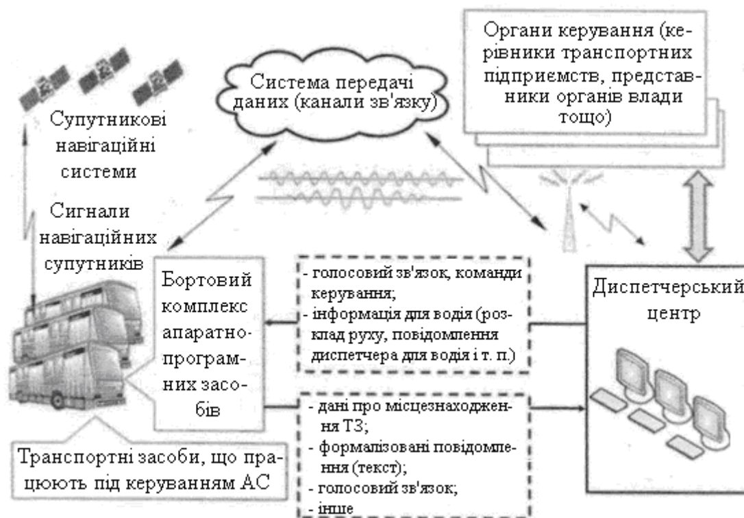
Рис. 10.5. Принципова схема роботи АС пасажирськими перевезеннями на базі супутникової навігації
