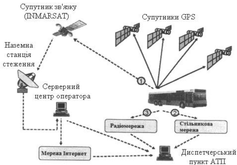
Рис. 5.9. Схема роботи диспетчерської навігаційної системи з варіантами передачі даних про місцезнаходження транспортного засобу
