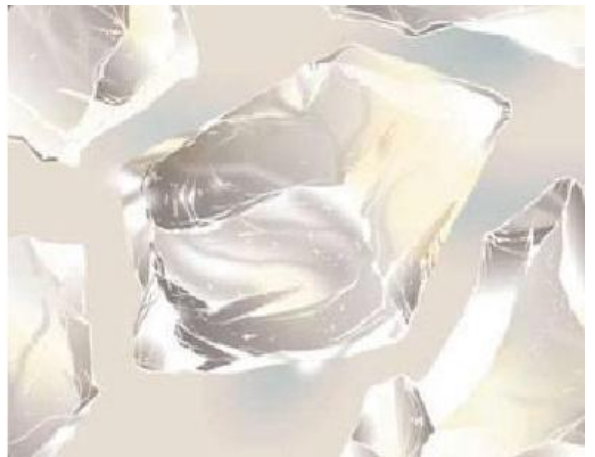
Рис. 8 - Біоскло – порошок (а), вигляд частинки під мікроскопом (б)
