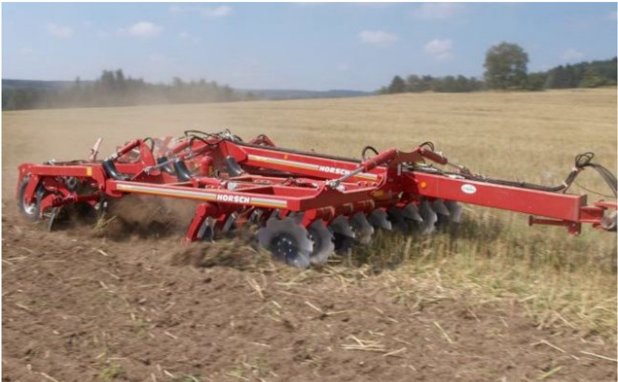
Рис. 12. Культиватор HORSCH TIGER 4MT із шириною захвату 4 м
