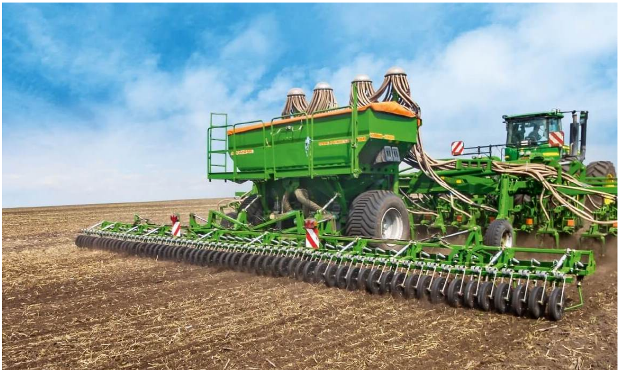
Рис. 14. Сівалка Primera DMC із шириною захвату 9 м
