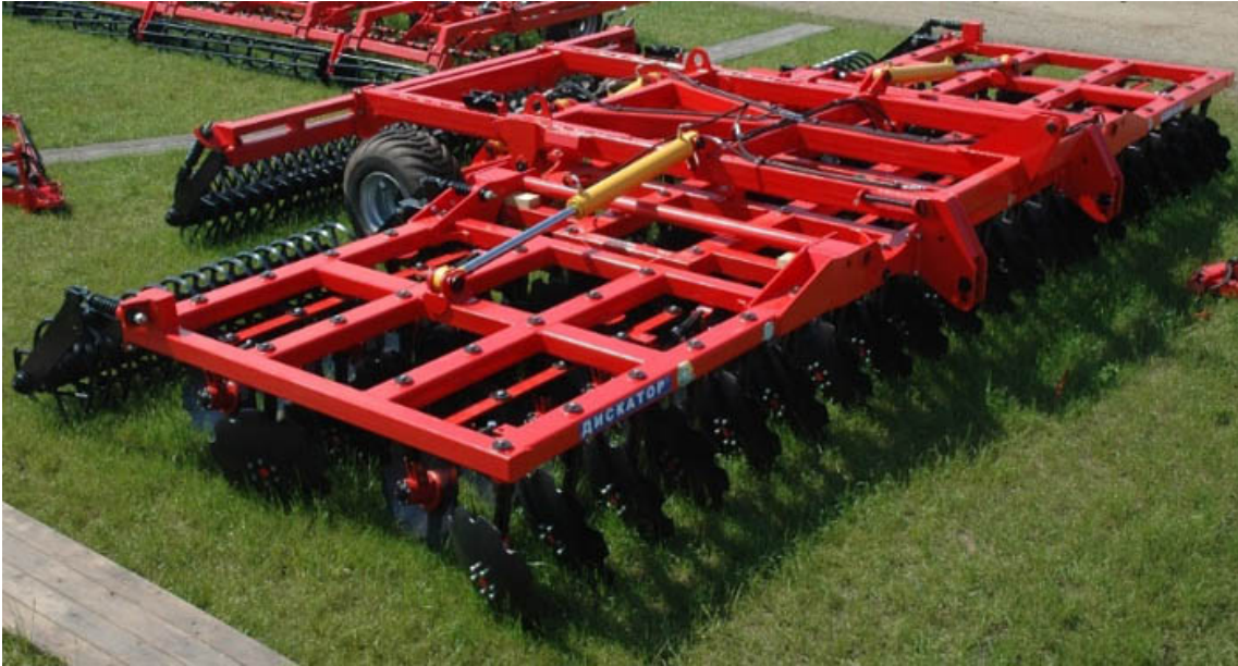
Рис. 11. Дискатор причіпний чотирирядний БДМ із шириною захвату 8 м. Працює в агрегаті з тракторами потужністю від 400 к.с.
