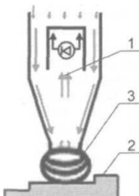
Рис.14. Схема роботи ближньопольного оптичного лазерного силового мікроскопу: 1 – луч лазера; 2 – поверхня, що досліджується; 3 – крапля води.
