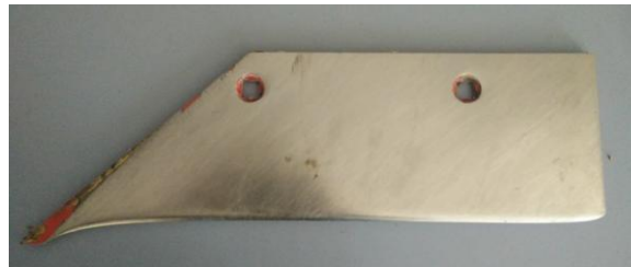
a б Рис. 1. Леміш плуга: а – новий; б – зношений.
