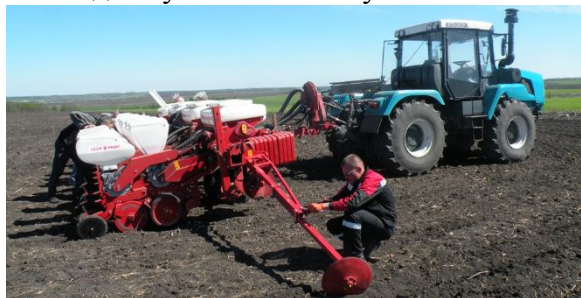
Представники АТ «Ельворті»: польові налаштування експериментальної сівалки для сумісного висіву просапних культур (ДП ДГ «Кутузівка», Харківський р-н, Харківська обл.)
