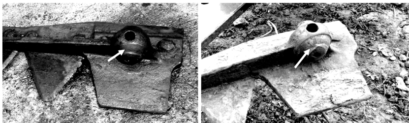
Рис. 2. Характер зношування з'єднувального шарніра ножа
