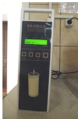
Рис. 1. Вигляд приладу «Екомілк» з визначення фізико-хімічного
