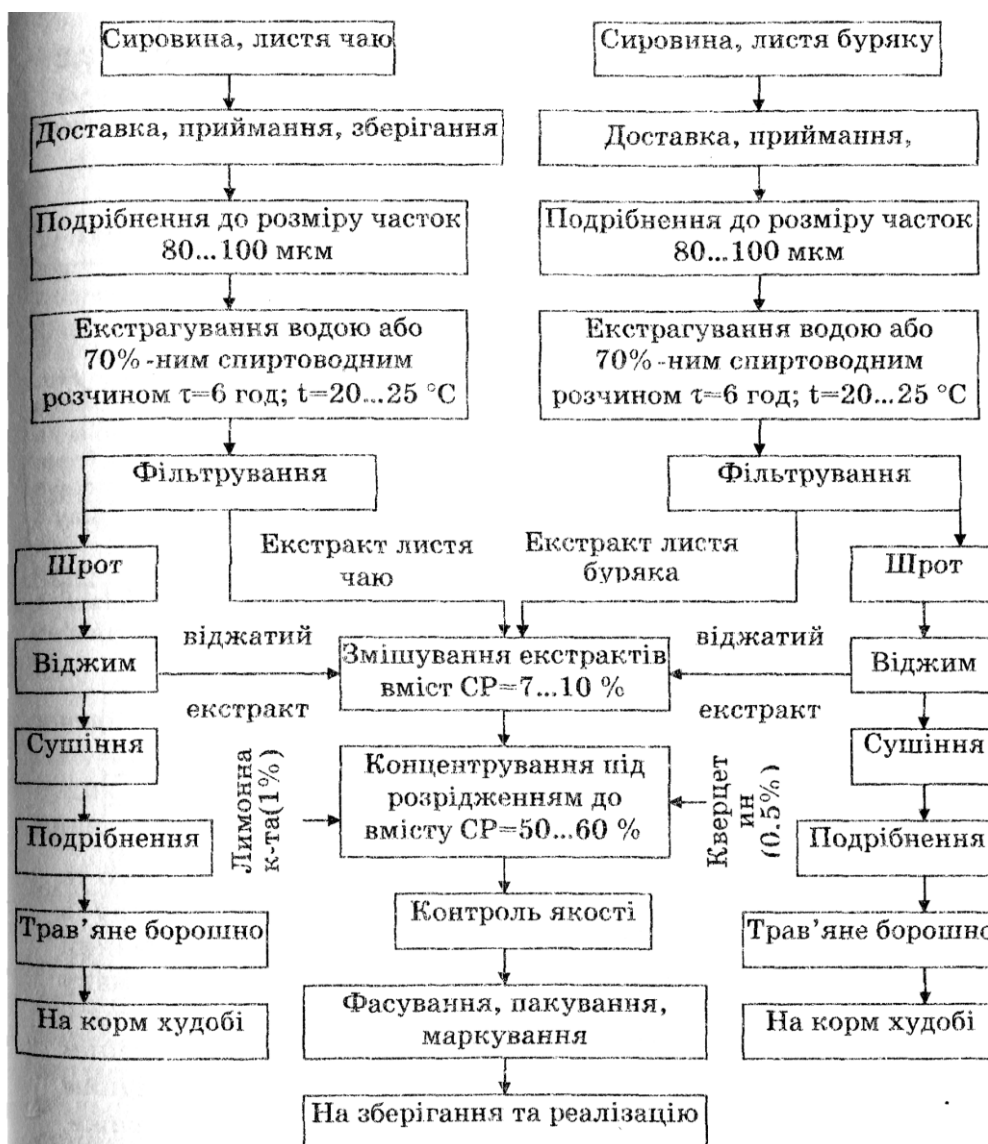
Рис. 1. Принципова технологічна схема отримання барвників з листя чаю та зеленої маси буряків
