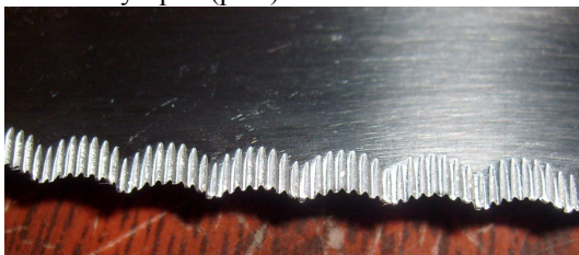
Рисунок – Форма ріжучого краю леза ножа кутера
