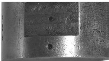
Рис.1. Поверхность вкладыша подшипника скольжения, поврежденная щелевой и фреттинг коррозией
