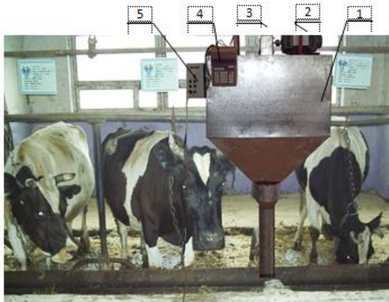
Рис.1. Загальний вигляд автоматизованого індивідуального роздавача-дозатора комбікормів: 1 – бункер індивідуального роздавача-дозатора; 2 – електродвигун для приводу конусно-лопатевого робочого органа; 3 – вимірювач частоти обертання робочого органа; 4 – мікропроцесорний блок керування роздавачем-дозатором; 5 – блок живлення.
