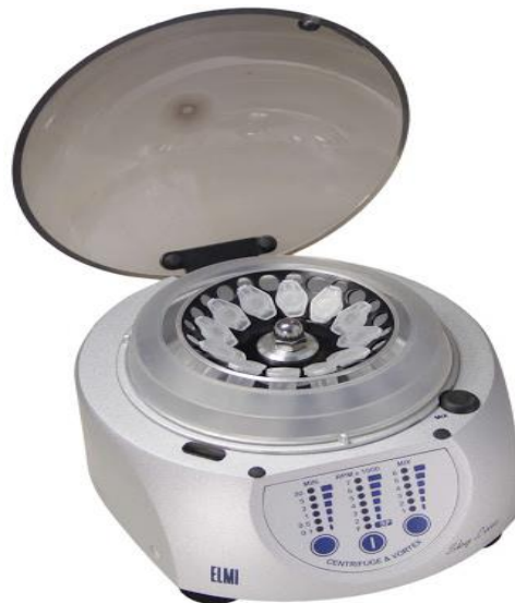
Рис. 72. Лабораторна центрифуга, розрахована на пробірки Еппендорфа об'ємом 1,5; 0,5 і 0,2 мл
