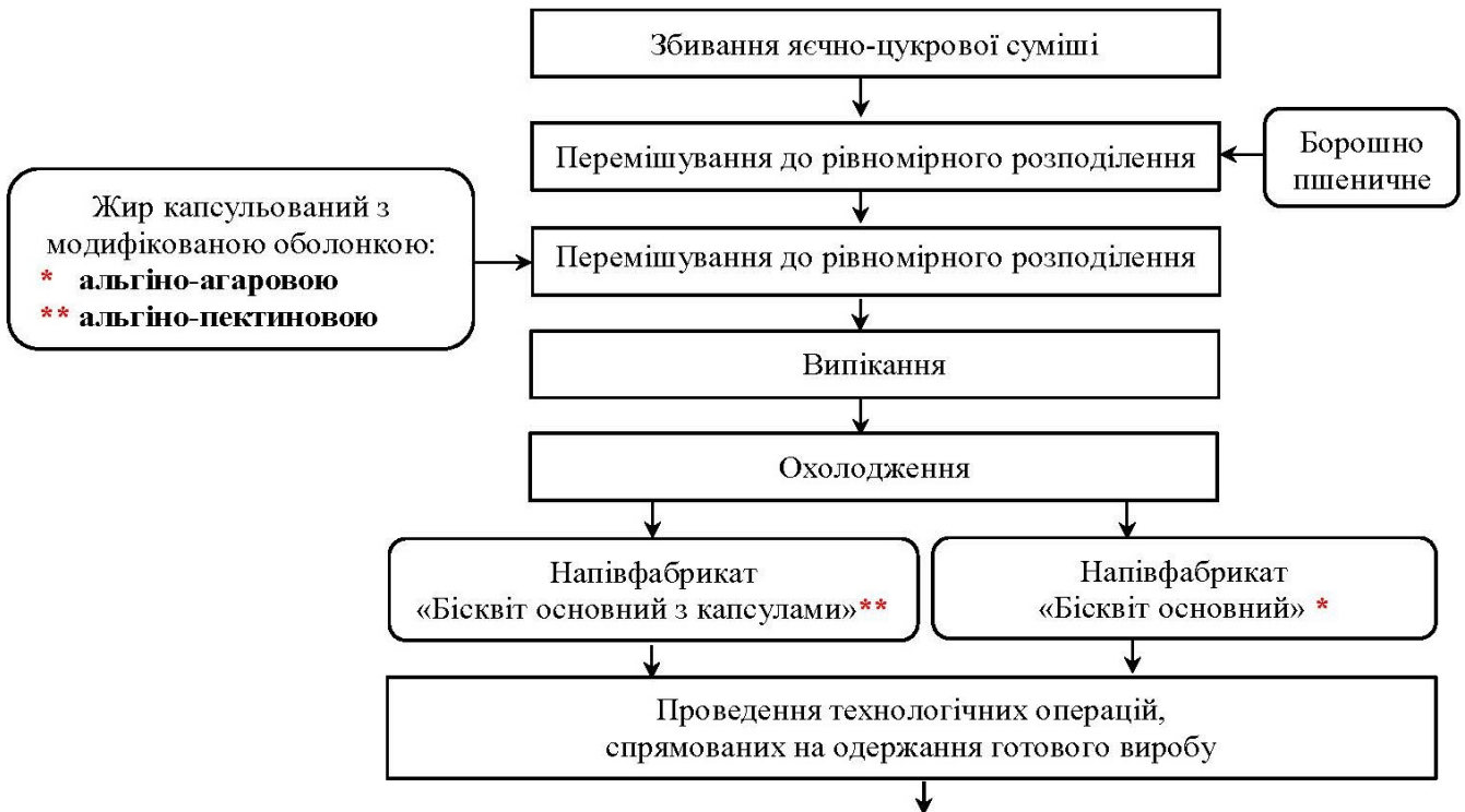
Рис. 15. Модель технологічної системи виробництва напівфабрикату «Бісквіт основний» із використанням жиру капсульованого
