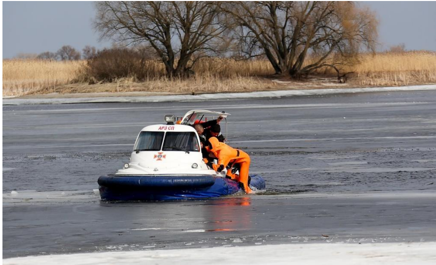
Рис. 4.10 аварійно-рятувальний катер на повітряній подушці
