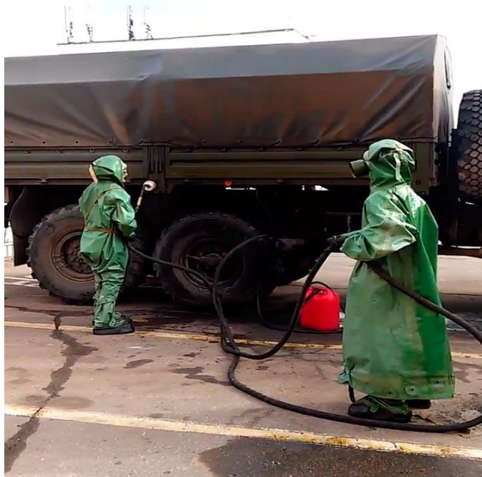
Рис. 3.18 Приклад проведення дегазації з використанням фізико-хімічного способу
