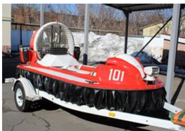
Рис. 4.7 Аероглісер з повітряним гвинтом «Торнадо»
