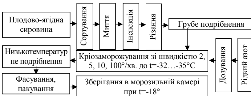
Рисунок – Технологічна схема виробництва наноструктурованих поре із ягід з використанням кріогенного заморожування та низькотемпературного подрібнення
