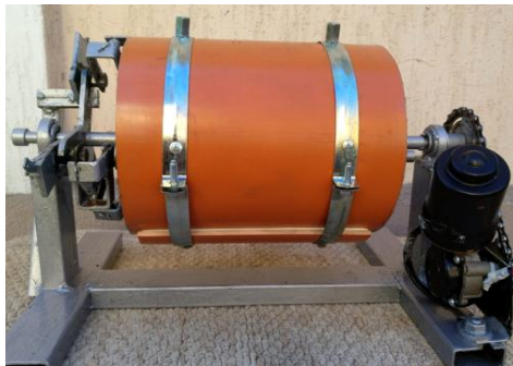
Рис. 2. Фізична модель масловиготівника
