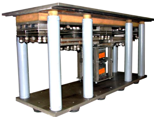
Рисунок 1 – Тримасовий міжрезонансний вібростіл з електромагнітним приводом
